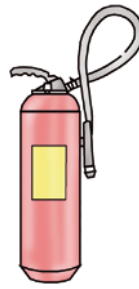
Sl.32. Aparat pod stalnim tlakom za početno gašenje požara prahom. Dijelovi aparata jesu spremnik, ručica za aktiviranje, osigurač, crijevo i mlaznica te često manometar. Na aparatu se mora nalaziti naljepnica s rokom uporabe. Najmanje jednom godišnje aparat provjerava ovlaštena pravna osoba. Spremnik je pod stalnim tlakom od cca 15 bara.
